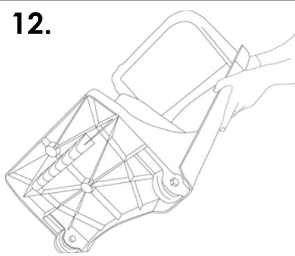
Die Tür des Behälters ist mit zwei Rädern ausgestattet. Somit kann die Tür ohne Anstrengung aus dem Behälter gerollt werden. Dieses erleichtert den Zugang zu dem Müllsack.
