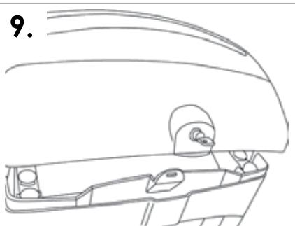
Für Modelle, welche mit Schloss ausgestattet sind, drücken Sie nach dem Schliessen des Deckels das Schloss, so dass dieses verriegelt ist.
