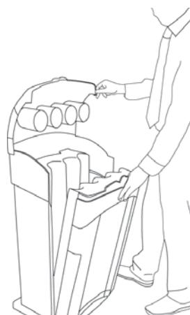
Die Tür kann jetzt zurückgekippt werden. Somit wird der Sack zwischen den Stapelröhren eingeklemmt.
