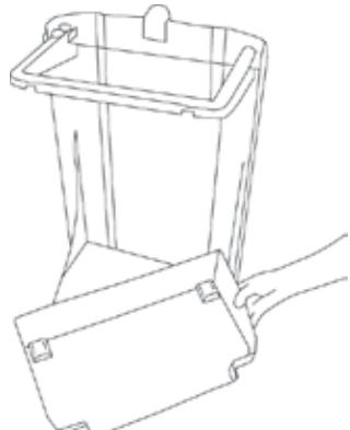
Der Behälter wird mit einer Auffangschalle geliefert, die sich im Boden der Tür befindet. Die Schalle fängt eventuell auslaufende Flüssigkeiten auf und ist abnehmbar, um diese leicht zu leeren und zu reinigen.
