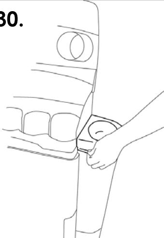
Öffnen Sie den Deckel des Behälters, um danach den Oberteil des Reservoirs mithilfe des Griffes an der Vorderseite abzunehmen.
