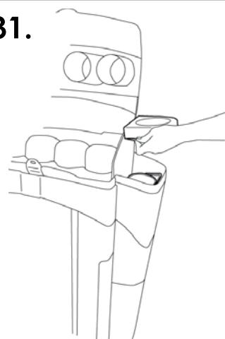
Nachdem der Oberteil des Reservoirs abgenommen worden ist, haben Sie leicht Zugang zu dem Auffangbehälter des Reservoirs.
