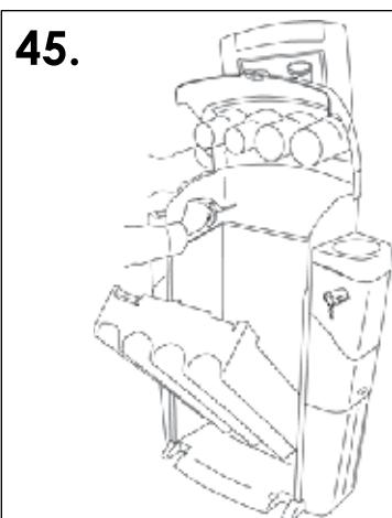
Schrauben Sie den Plakathalter - sowie in der oben stehenden Abbildung angezeigt - mit den fünf dafür vorgesehenen Schrauben an den Behälter fest.
