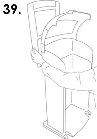
Öffnen Sie den Behälter und entfernen Sie die Tür. Positionieren Sie den Plakathalter an der Rückseite des Behälters und richten Sie die fünf Schraublöcher aufeinander aus.
