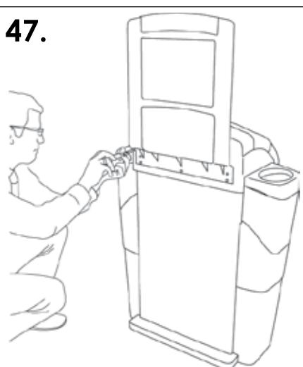
Schrauben Sie die Stapelrohre von der Rückseite des Behälters mithilfe der in Schritt 42 entfernten Schrauben fest.
