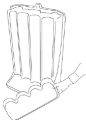
Der Behälter wird mit einer Auffangschalle geliefert, die sich im Boden der Tür befindet. Die Schalle fängt eventuell auslaufende Flüssigkeiten auf und ist abnehmbar, um diese leicht zu leeren und zu reinigen.
