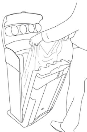
Lassen Sie einen Sack der korrekten Größe (800 x 1000 mm – erhältlich von Glasdon) zwischen beiden Hälften der Stapelröhren ein.
