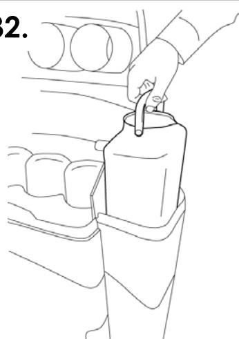
Nehmen Sie den Auffangbehälter aus dem Reservoir mithilfe des Handgriffes aus.
