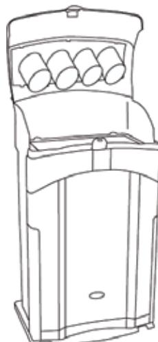
Heben Sie den Deckel so weit an, bis dieser von selbst in senkrechter Position hält.
